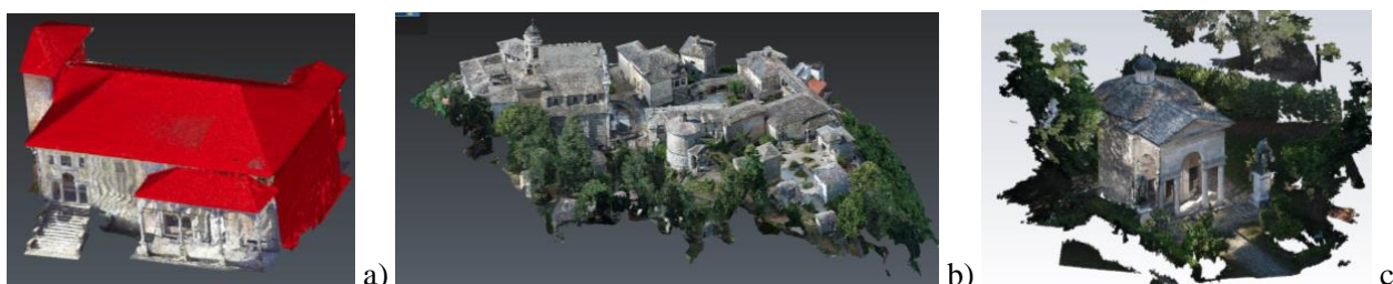
Figura 3. a) Complesso del Sacro Monte, b) a) Cappella 1, c) Unione nuvola fotogrammetrica (rosso) e LiDAR
