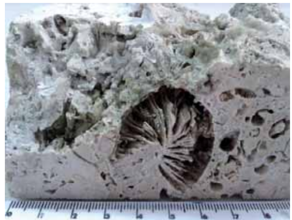
Fig. 6- Tessitura a coralli del campione (Immagine fornita dall'autore, 2014)
