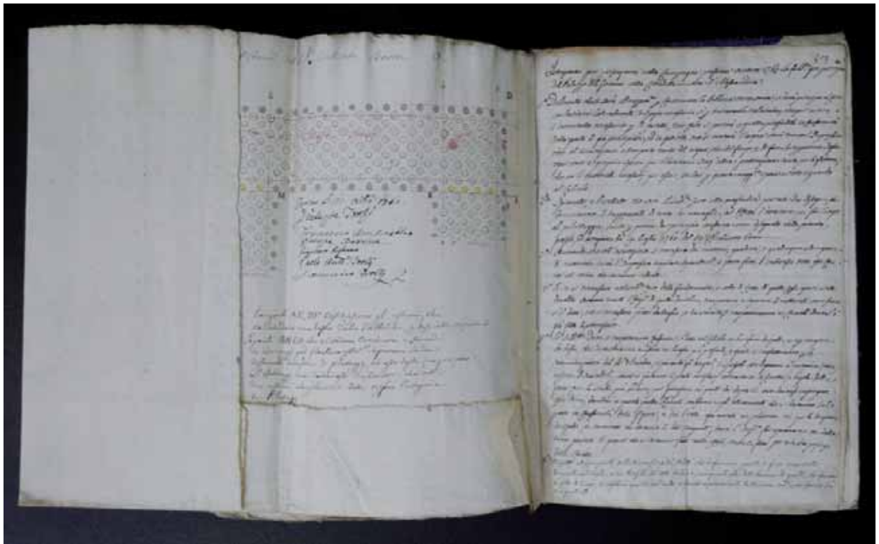
Fig. 1- Istruzione per le fondazioni del padiglione di levante della nuova fabbrica del Palazzo del Governo nella Cittadella di Alessandria, con modello per la misura dei 'pilotaggi' secondo il sistema dell'architetto Borra, 1762 (AST, Guerra, Azienda generale Fabbriche e Fortificazioni, Contratti, reg. 60)
