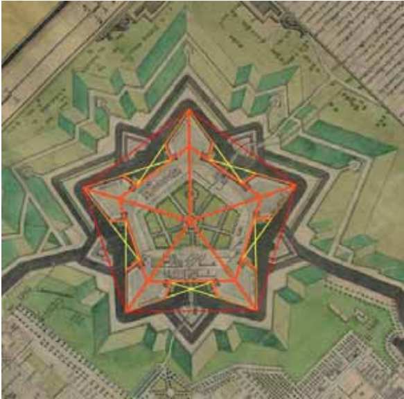
Fig. 3- Ignazio Amedeo Galletti, 1790. Pianta geometrica della Reale Città di Torino colla loro fortificazione. [570x840 mm]. (Archivio storico del Comune di Torino, Tipi e Disegni, 64-2-13), detail of the Citadel. Superimposition of the graphical analysis and geometric construction (in orange). Graphic overlay: Author
