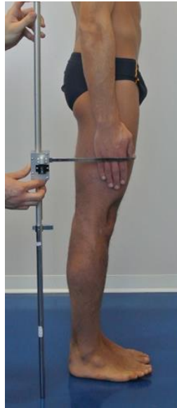
Figura A7: Misurazione dell'altezza nocca
