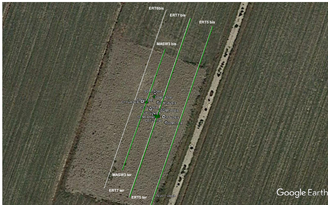
Fig 3. Mappa delle indagini post blast test presso il sito sperimentale di Mirabello: il colore bianco è collegato alla campagna di maggio e il colore verde indica le indagini di luglio.
