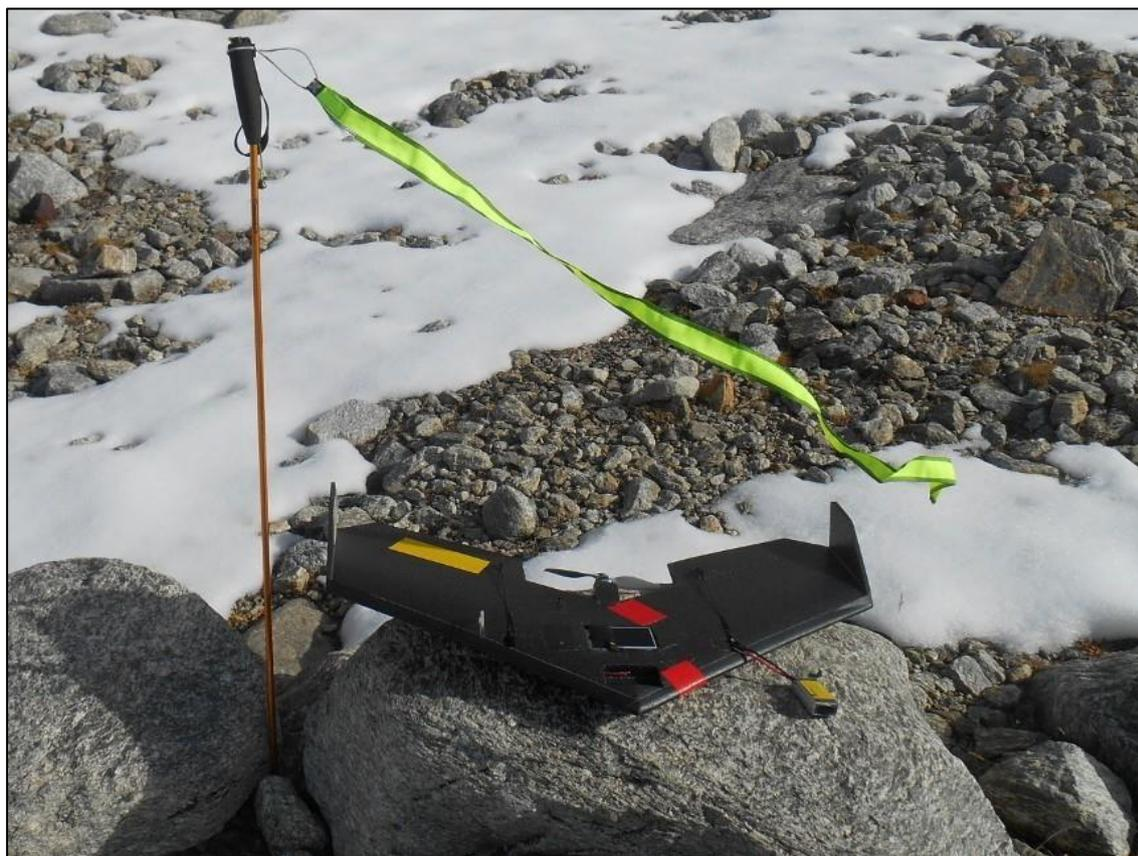
*Figura 135 - Drone ad ala fissa Swinglet CAM (SenseFly)*
