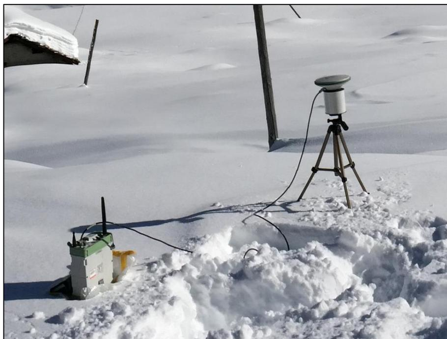
*Figura 125 - Prisma riflettore per laser scanner misurato con GNSS a doppia frequenza*
