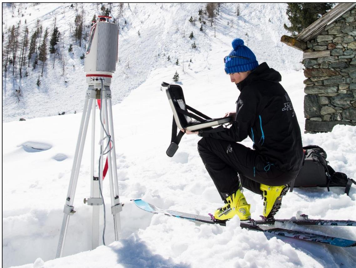
Figura 124 - Utilizzo in campo del TLS Riegl VZ 4000
