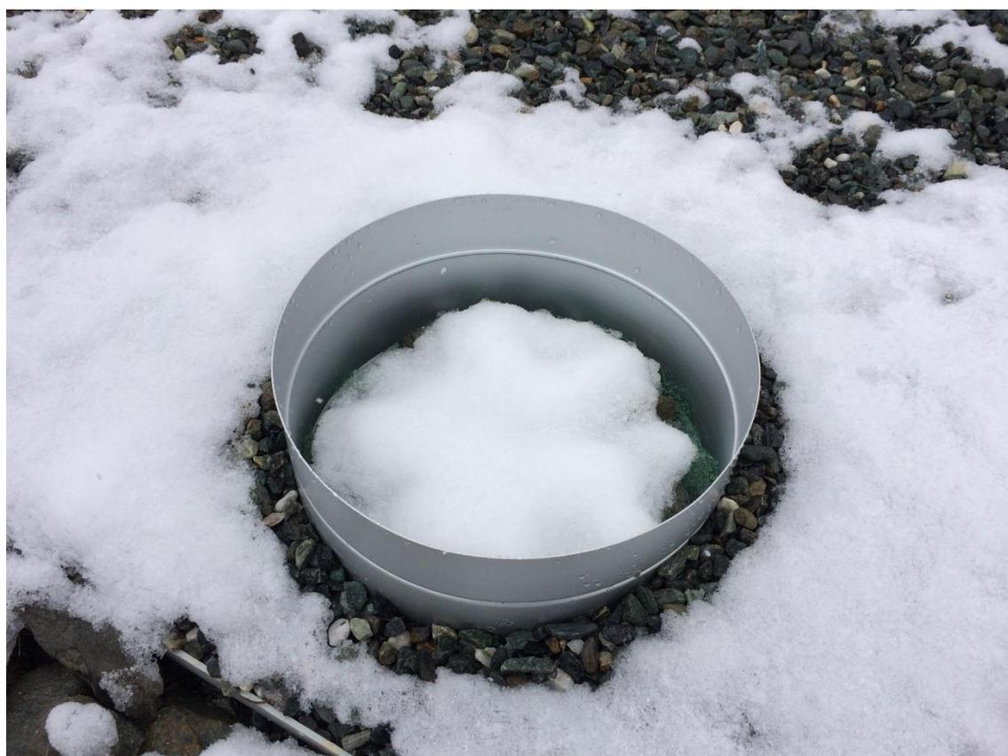
Figura 23 - Pluviometro interrato invernale
