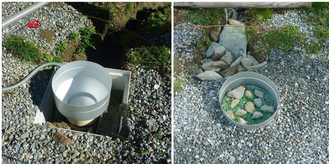
Figura 22 - Pluviometro interrato
