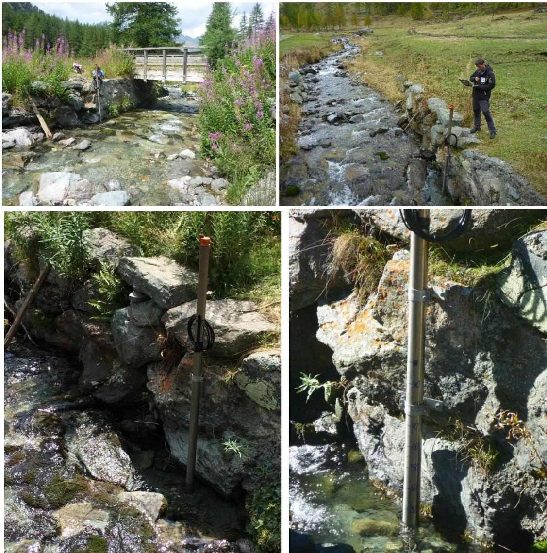
*Figura 51 - Sonda multiparametrica installata sul torrente Mascognaz*
