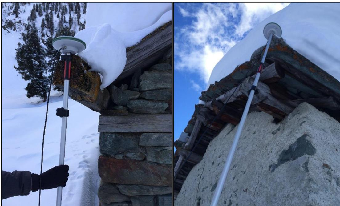
Figura 127 - Punti noti "battutti" con GNSS a doppia frequenza
