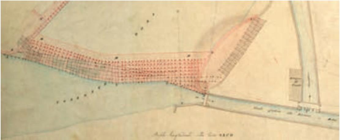
Sopra: pianta del 1840 con l'indicazione dei pali infissi nell'alveo della Dora per rifare la diga di derivazione del canale Meana.
