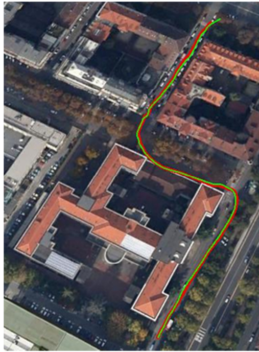
Figura 53. Confronto traiettorie ottenute dal filtraggio e lisciamento dei dati, con la traiettoria di riferimento - modello a 5 stati
