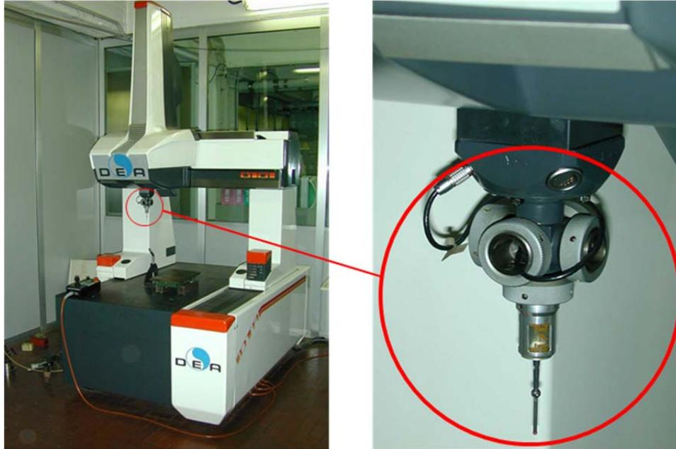
**Figura 4** Attrezzature di Laboratorio per il controllo in linea della Qualità. Dettaglio di una Macchina di Misura a Coordinate (CMM) utilizzate per misure dimensionali di componenti meccanici.
