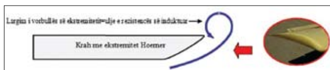
Figura 5. Profil krahut me ekstremitetet Hoerner, për të ulur rezistencën e induktuar
