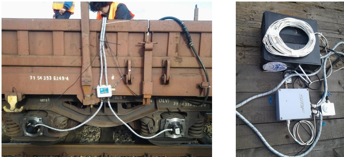
Figura 14: Sistema di monitoraggio Multicanale per un singolo carrello.
