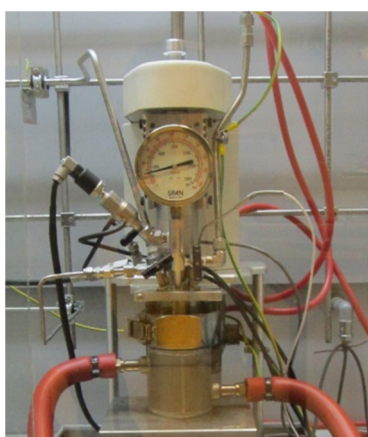
Figura 5.2: fotografia del reattore batch.
