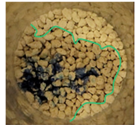
Figura 8.15: dispersione radiale dell'acqua ma non del colorante.
