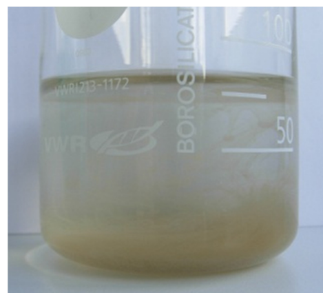
Figura 5.11: soluzione a base d'argento usata per la verifica della presenza di cloro.
