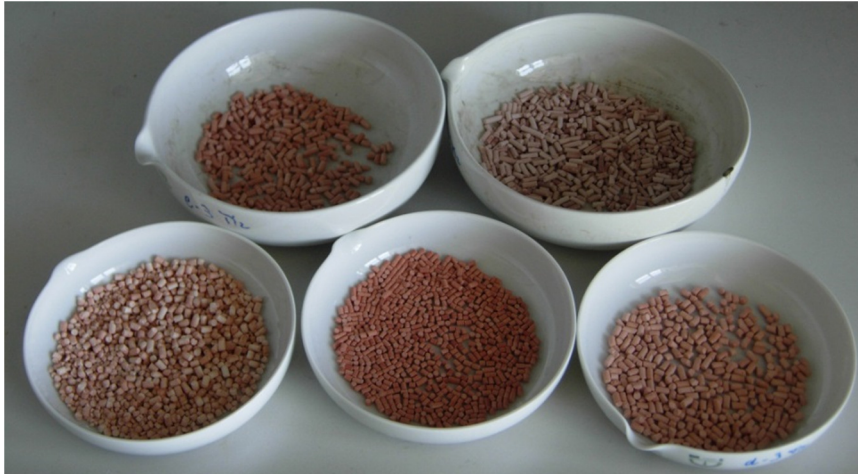
Figura 5.8: alcuni dei catalizzatori sintetizzati, prima della fase di calcinazione.
