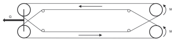
Fig. 9 - Schema del sistema funiviario con doppia fune portante traente.
