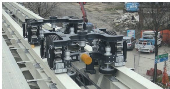
Fig. 1 - Esempio di un carrello per un APM con trazione a fune o CAPM.
