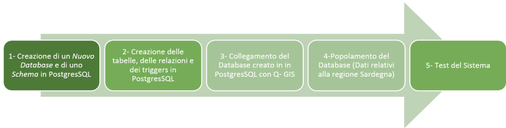
Figura 2 - Realizzazione del Database per AF3 in PostgreSQL and Q-GIS.
