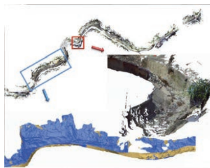
Figura 3.b Il modello del torrente Vernazzola rilevato con Laser scanner Focus 3D Faro Cam2: nuvola di punti, modello colorato e modello texturizzato
