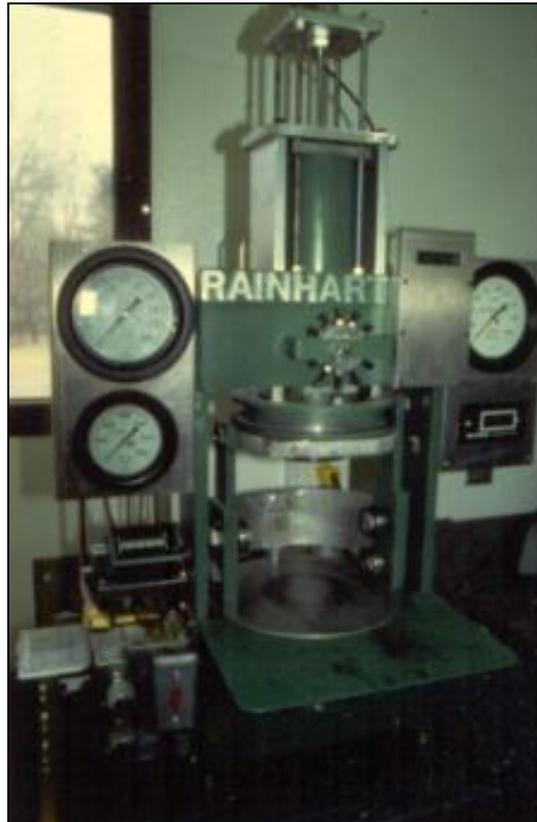
Figura 5.3.2.2: Il Texas gyrotory shear test machine modificato (1991)
