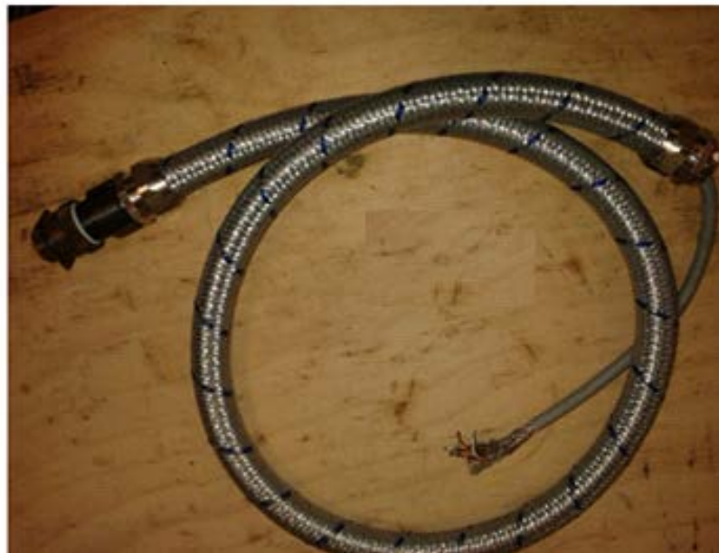
Fig. 109: Cavo con guaina esterna di protezione e connettore.
