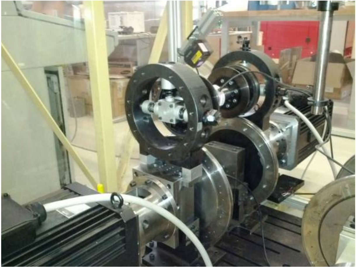
Fig. 49: Banco prova Roller-Rig in configurazione di sala singola per le prove di adesione.
