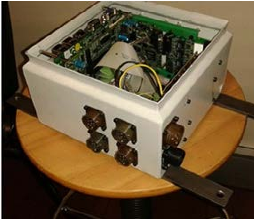
Fig. 107: Scatola contenente l'elettronica del sistema di monitoraggio.
