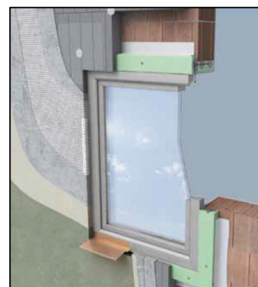
Figura 5.56. Klimatrave utilizzato come cornice isolante
