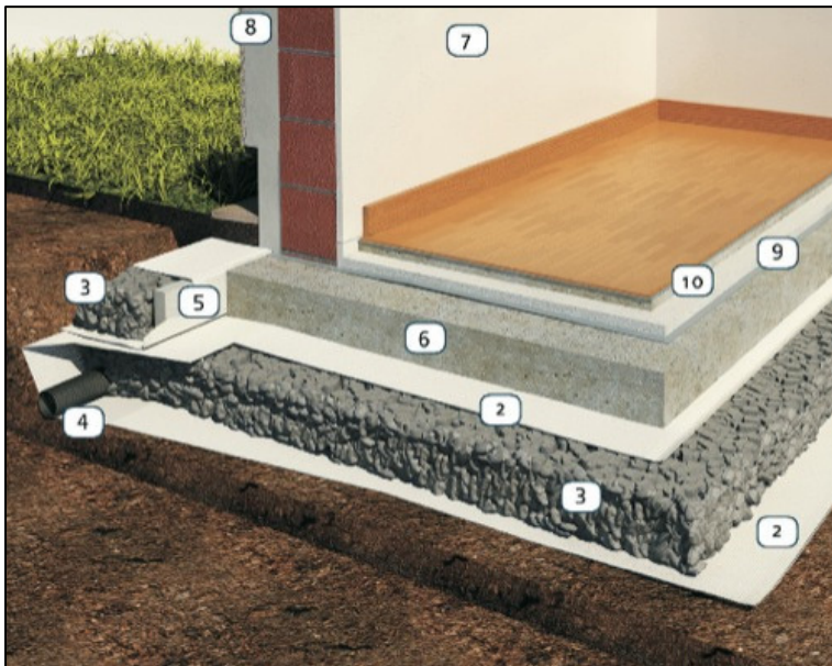
Figura 5.46. Platea di fondazione in vetrocellulare
