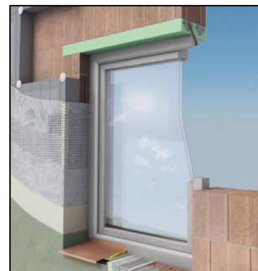
Figura 5.55. Klimatrave utilizzato come architrave coibentata
