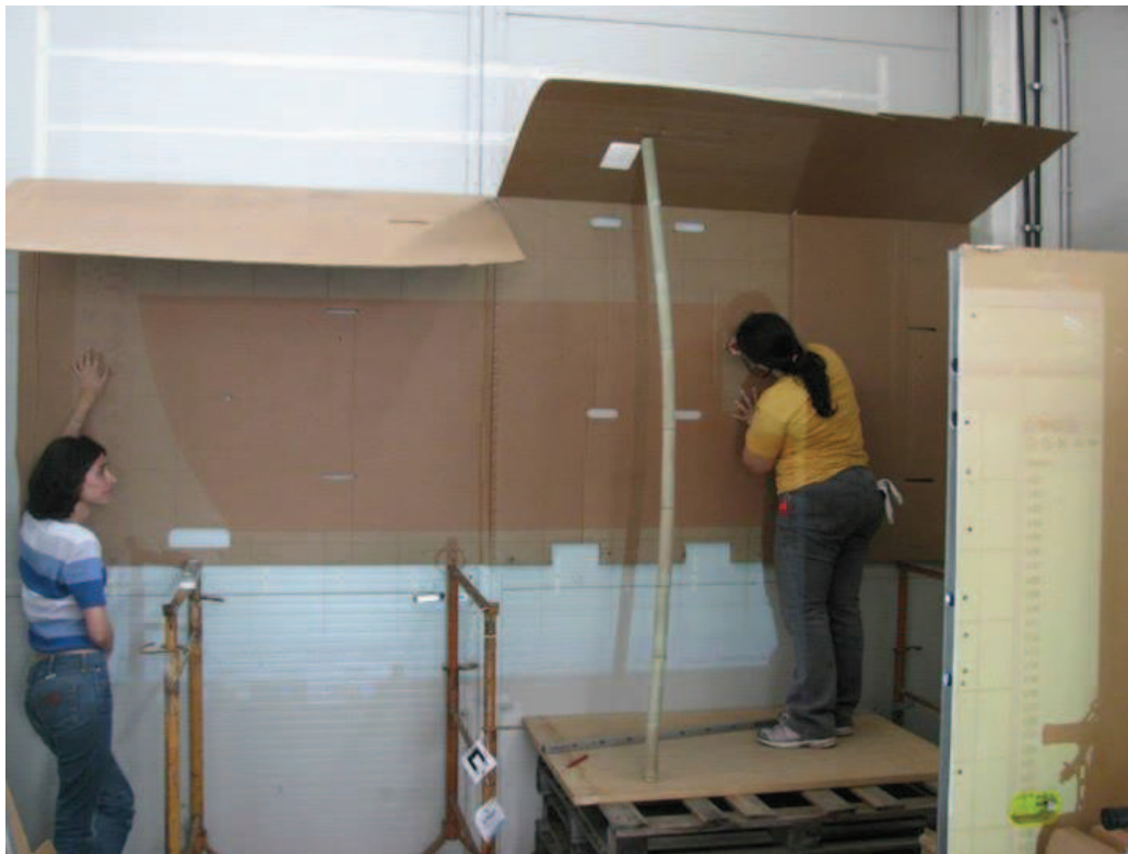
Figura 6.8: Il passaggio da bit ad atomo presso il laboratorio LATEC: l'immagine proiettata a scala reale viene trasferita manualmente sui supporti di cartoni. Verrà successivamente ritagliata e opportunamente montata.
