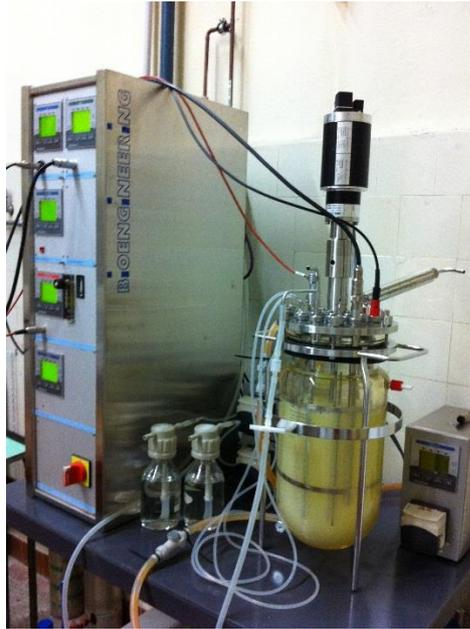
*Figura 8.2: sistema R'ALF® Bioengineering® durante una fermentazione con scotta.*
