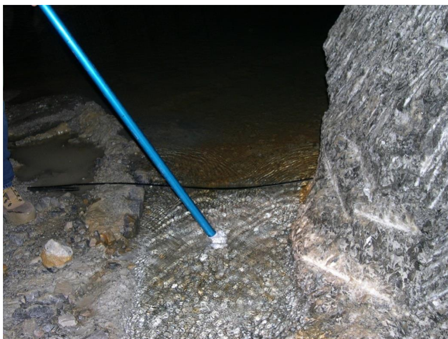
Figura 76: Misura di portata con mulinello del flusso proveniente dall'inrush
