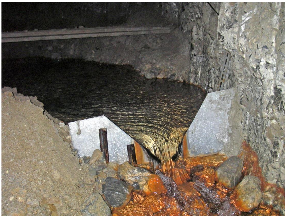
Figura 93: Stramazzo triangolare per la misura delle portate del flusso totale
