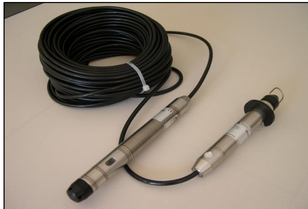
Figura 13: Sonda dotata di trasduttore di pressione e datalogger integrato
