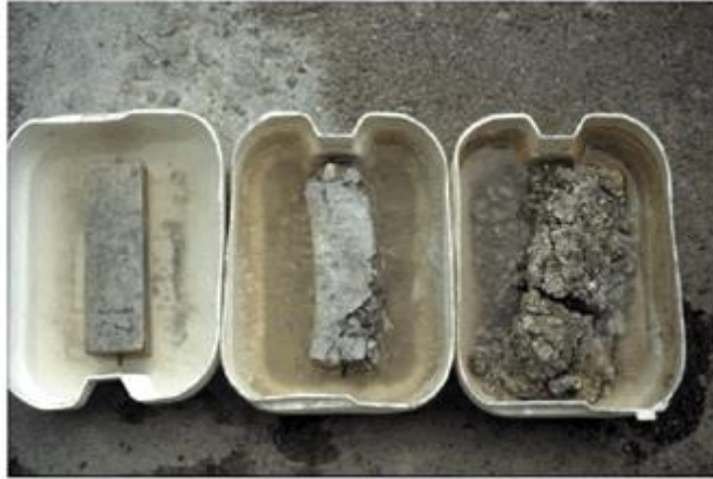
Figura 21: distruzione progressiva di un provino di conglomerato cementizio immerso in un ambiente solfatico. Nel centro il provino si è deformato per formazione di ettringite, destra il provino si è disgregato per formazione di thaumasite
