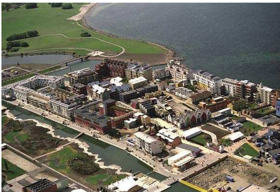
Figura 11. Gli edifici più alti sono disposti sul perimetro del distretto in modo da ostacolare i venti freddi invernali provenienti dal mare
