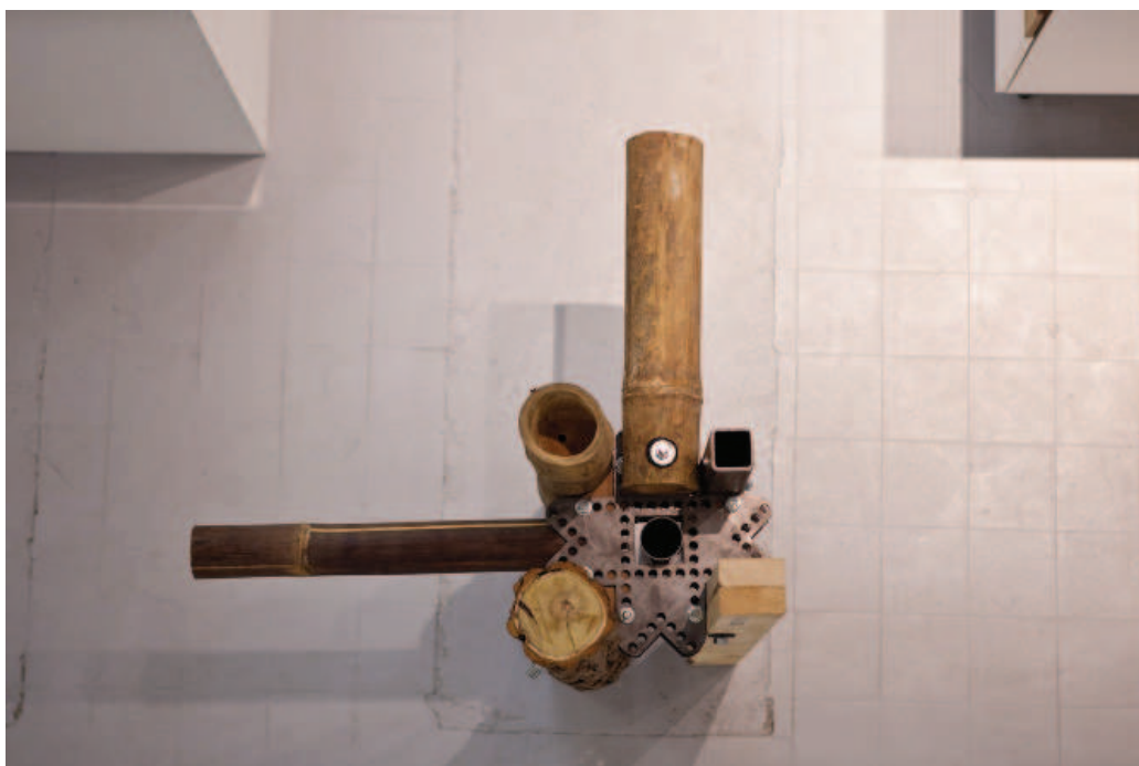
Figura 4.8: Il progetto di giunto tra elementi a sezione quadrata ed elementi a sezione tonda, sviluppato da Brussels Cooperation per il progetto di un mercato coperto a Katanga, in Congo. (fonte: http://openstructures.net/ ).
