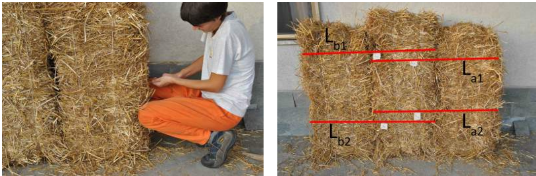
Figura 6.14: Passaggio della corda nella parte superiore e legature della balla: superiore (La1) e laterale (La2) (foto A.R. Bertorello, 29.10.13)
