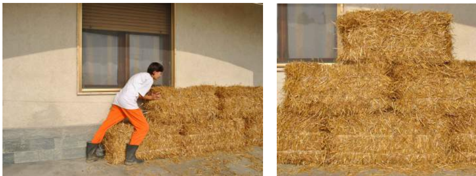
Figura 6.11: Prove di schiacciamento e accostamento della paglia e evidenziazione degli spazi tra le varie balle di paglia (foto A.R. Bertorello, 26.10.13)
