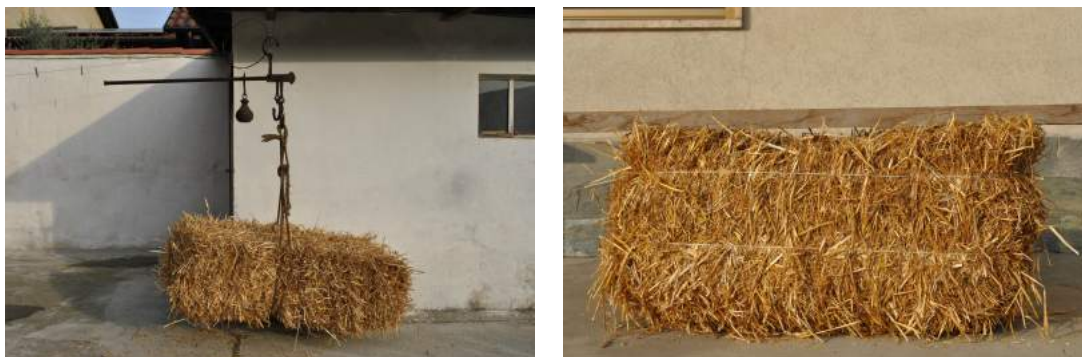
Figura 6.7: A sinistra: peso della balla di paglia (15,8 kg) (A.R. Bertorello, 26.10.13); a destra: balla non perfettamente rettangolare e con difetti nella legatura (A.R. Bertorello, 26.10.13)
