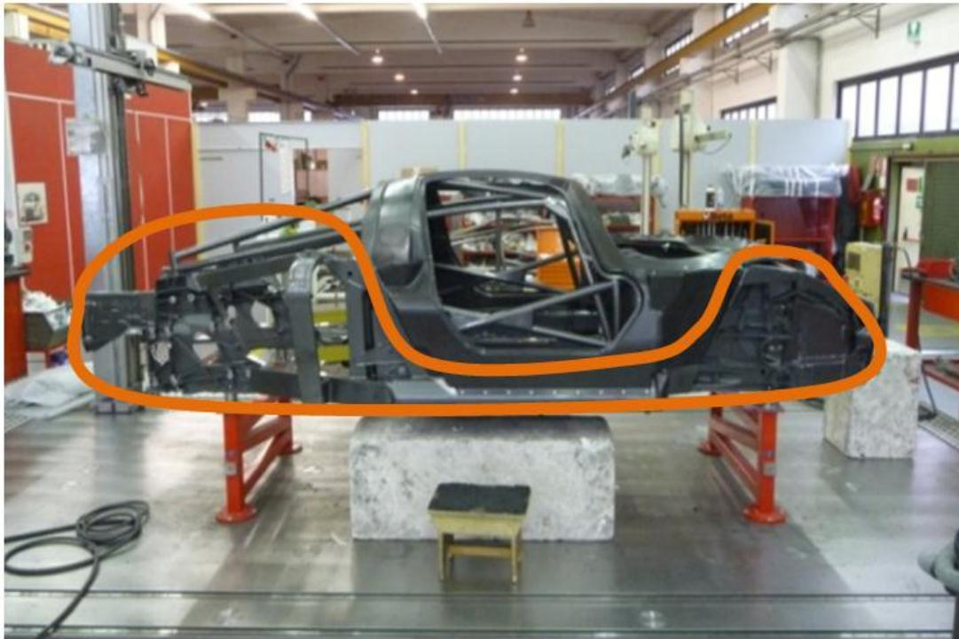
**Figura 5.2: parte del telaio della Ferrari F430 mantenuta sulla P4/5 Competizione**
