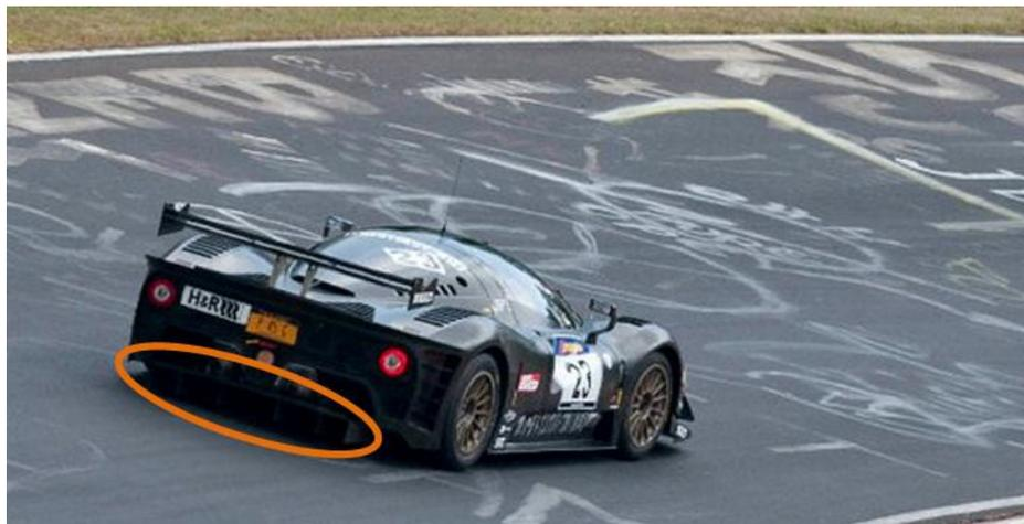
**Figura 5.4: diffusore posteriore della P4/5 Competizione**
