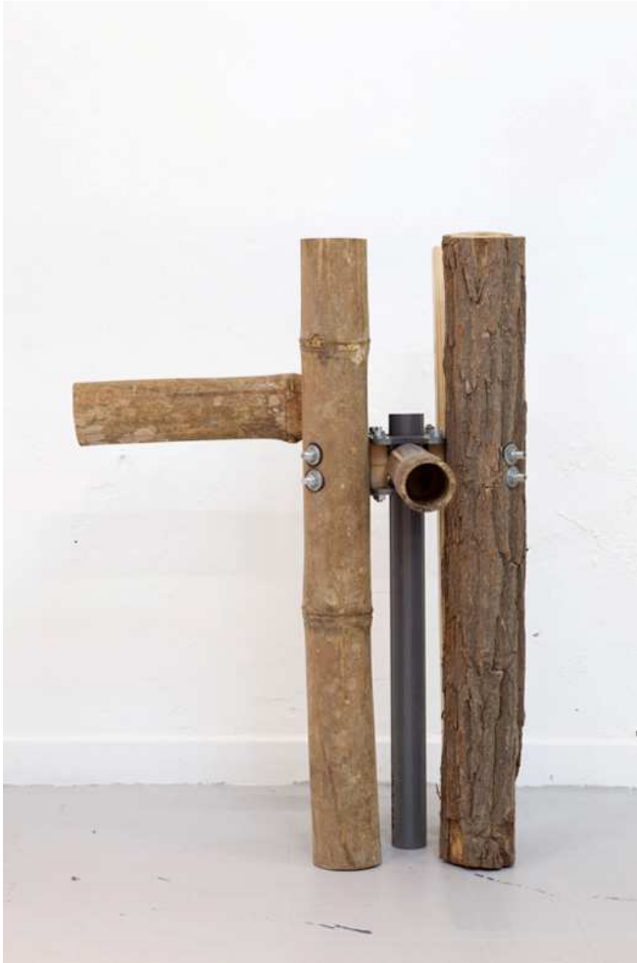
Open Structures – Prototipo di un nodo strutturale adattabile a diversi materiali sviluppato da Brussels Cooperation per il progetto pilota di una scuola in Burundi. L'elemento è stato realizzato sulla base della griglia Open Structures e compatibile con gli altri elementi sviluppati dalla comunità – fonte immagine: http://www.brusselscooperation.be/
