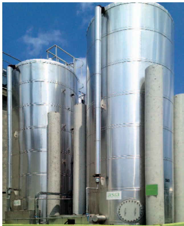
Figura 2. I serbatoi di stoccaggio degli olii vegetali: soia, girasole, colza, palma, jatropha o esausti da frittura, provenienti dalle aziende di raccolta
