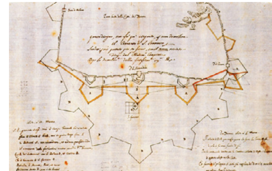
Fig. 3 - [1657, 13 marzo]. A Disegno [...] con fare li sei Baluardi come si vede dall'ordine dé 13 marzo. Questo disegno non fu poi eseguito, per non demolire / il Convento di S. Francesco, sendosi poi portato più in fuori, come il novo recinto [...]. Il colorito di Giallo pare meglio parere che fare la linea Rossa / e solo si fa una faccia di più. / Poiche entrando dentro con la cortina colorita di Rosso s'haverano / di gettare abasso molte case [...]. Immagine tratta da: COMOLI MANDRACCI, Vera, MAROTTA, Anna (a cura di), Tortona e il suo Castello. Dal Dominio Spagnolo al Periodo Postunitario, SO.G.ED. Edizioni, Alessandria 1995, p.23.
