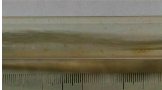
Figura 287: W_{aria} = 0,25 g/s, \Delta z \sim 1,25 m; Portata totale W1 ; elica D = 1,39 m. Prove tipo II Caso 1 Circuito B.
