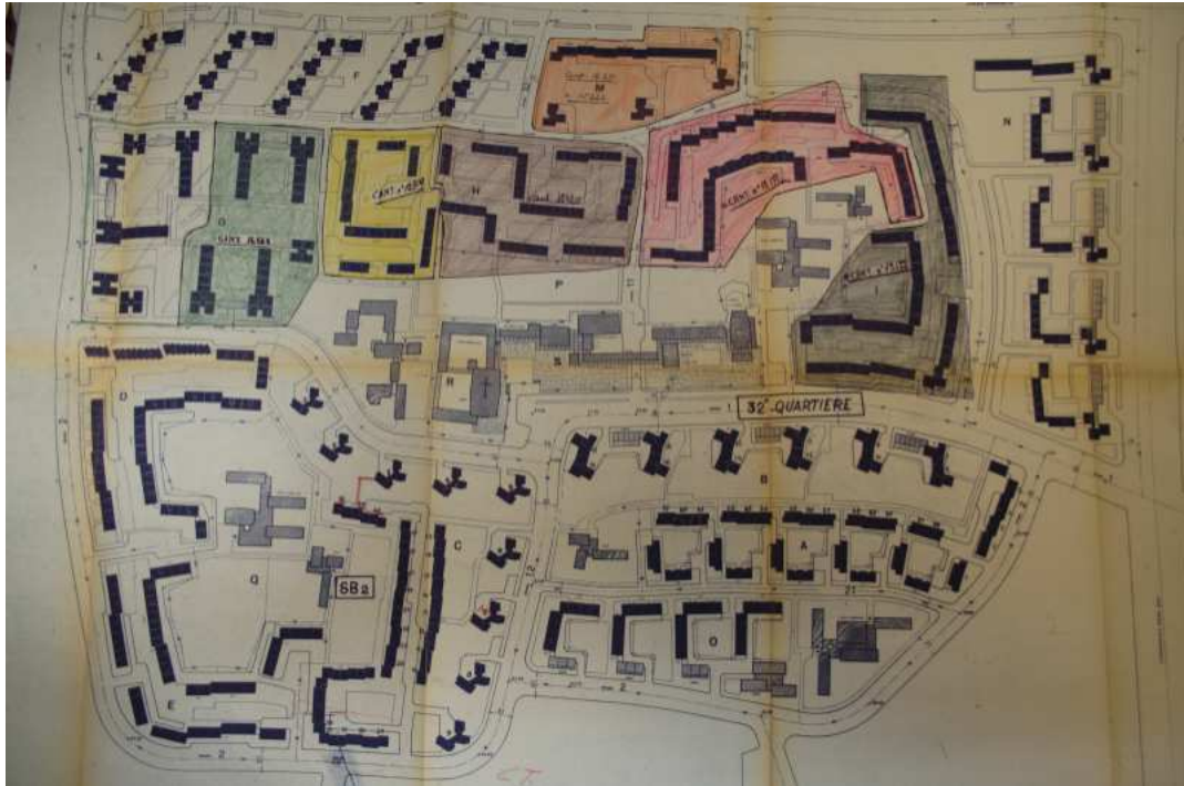
Figura 10 Piano particolareggiato del quartiere con la suddivisione in cantieri durante la costruzione
