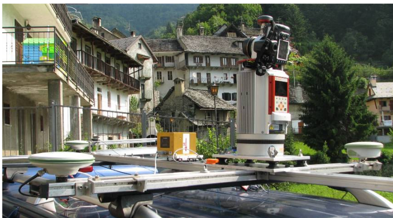
Figura 2 – piattaforma del sistema mobile
