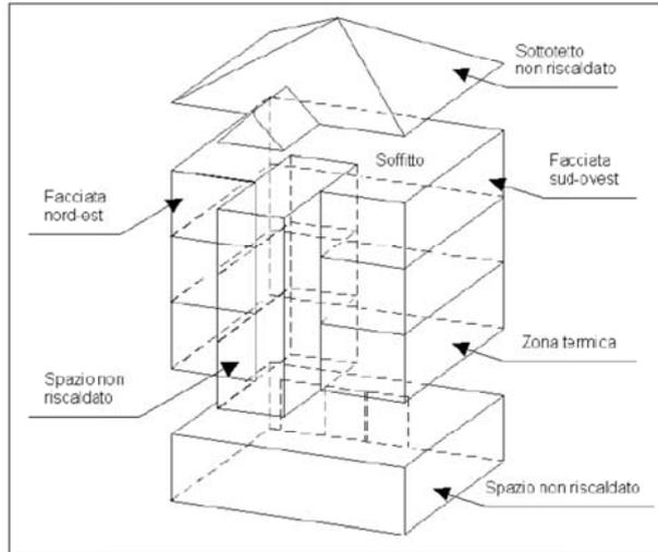
Figura C.1: Esempio di individuazione delle zone termiche, degli spazi non riscaldati e delle facciate.
