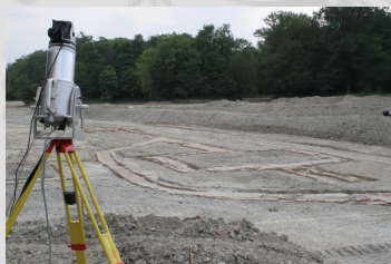
Rilievo LIDAR terrestre di emergenze archeologiche
