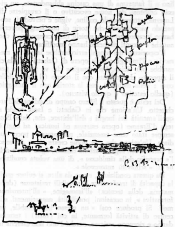
Gabetti/Isola - Schizzo della soluzione definitiva in pianta e alzato. La figura a destra enumera le destinazioni principali: tribunale, aule, custode, pretura, procura, polizia.
