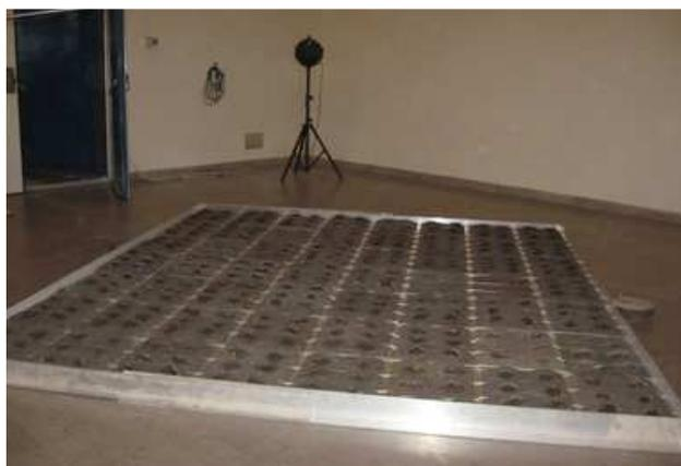
Figura 64 - Il campione GMS1 senza piante e substrato esterno in camera riverberante presso INRiM.
