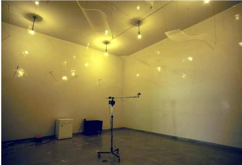
Figura 62 - La camera riverberante all'interno della quale sono state effettuate le misure del coefficiente di assorbimento acustico, presso l'INRiM di Torino. (Fonte: [www.inrim.it](http://www.inrim.it))
