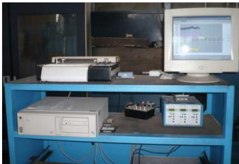
Figura 8.26 - Gruppo di acquisizione delle forze di taglio (amplificatore e computer con scheda di acquisizione)
