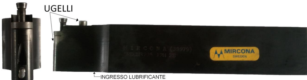
Figura 3.17 - Vista frontale e laterale del portautensili modificato per ospitare al proprio interni gli ugelli per la lubro-refrigerazione
