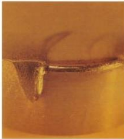
Figura 2.27 - Usura per intaglio
