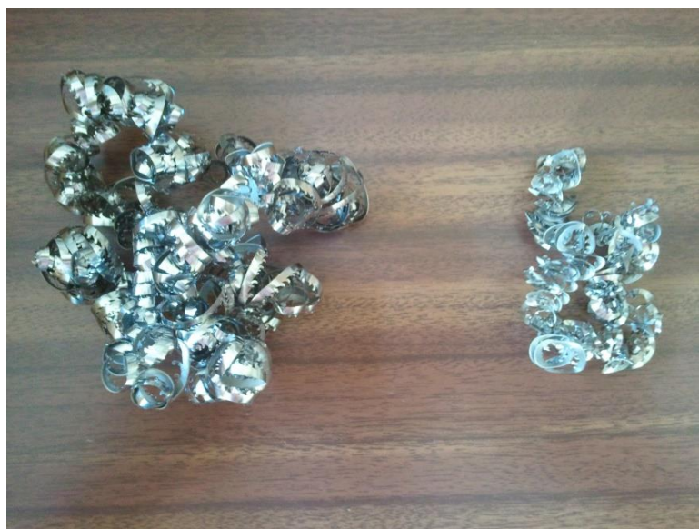
Figura 4.24 - Truciolo prodotto in assenza di lubro-refrigerante (condizione Dry); V_c = 35 m/min (sinistra), V_c = 50 m/min (destra)
