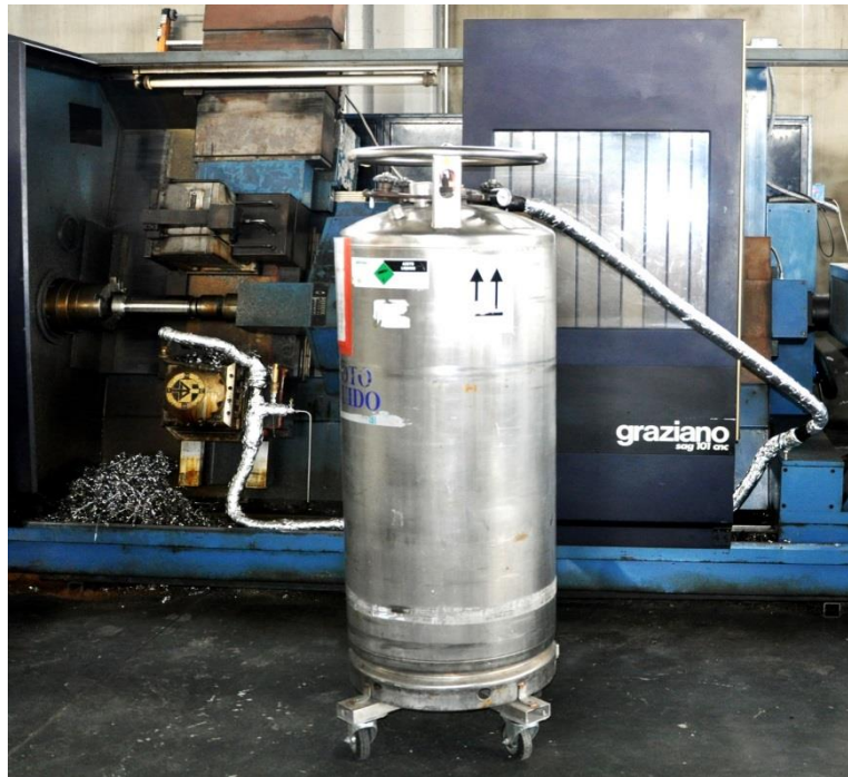
Figura 3.13 - Sistema "prototipo" refrigerazione criogenica
