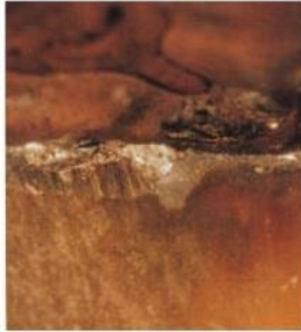
Figura 2.30 - Scheggiatura del tagliente
