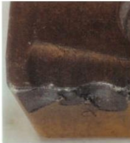
Figura 2.31 - Rottura del tagliente
