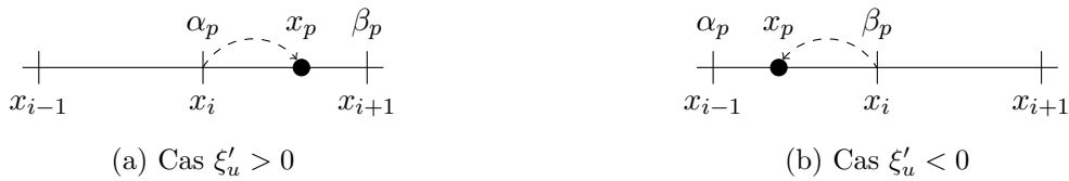
Figure V.6: Configuration 1D après une étape de transport dans l'espace physique (comportement similaire dans l'espace des vitesses avec \xi'_u \equiv a_u )
