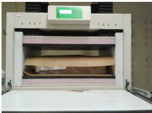
Fig. 7.93, Prova termica con l'apparecchio Lasercomp FOX600, sul campione in terra battuta B
