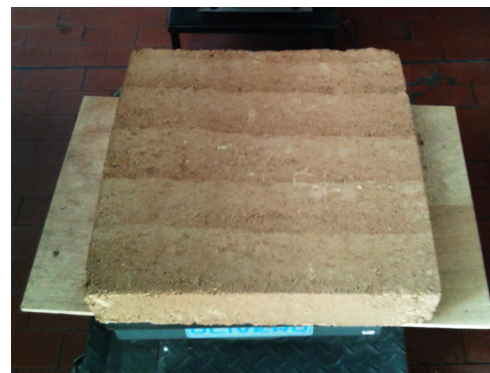
Fig. 7.92, Il campione in terra battuta B, \omega di compattazione 15%, viene pesato prima di essere sottoposto ai test termici.
