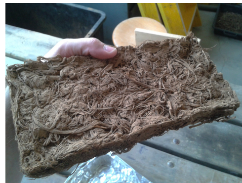
Fig. 7.89 , Provino in terra alleggerita con canapa essiccata.
