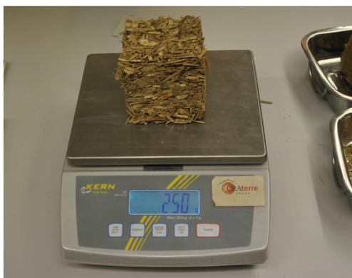
Fig. 7.73, Il campione viene pesato dopo l'essiccazione in forno.
