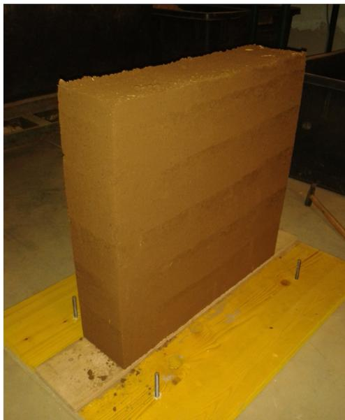
Fig. 7.67, Uno dei campioni realizzati, pronto per l'essiccazione.
