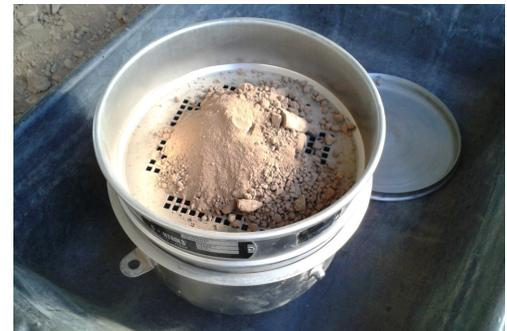
**Fig. 7.46-7.47,** Prova proctor: la terra essiccata viene sminuzzata con un martello di gomma e passata al setaccio da 5mm.
