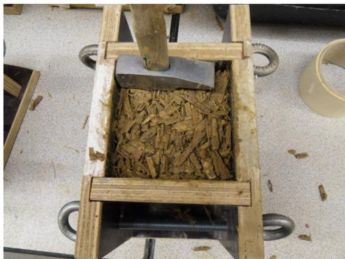
Fig. 7.72, L'impasto viene leggermente compattato all'interno del cassero utilizzando la testa di un piccolo martello.
