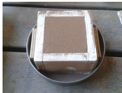
Fig. 7.75, Volume di riferimento usato per quantificare le proporzioni di materiale nell'impasto.
