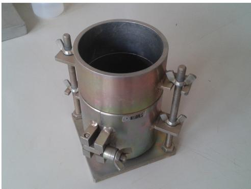
Fig. 7.44, Lo stampo utilizzato per le prove di compattazione proctor standard è un modello di dimensione piccola, (vedi tabella 7.8).
