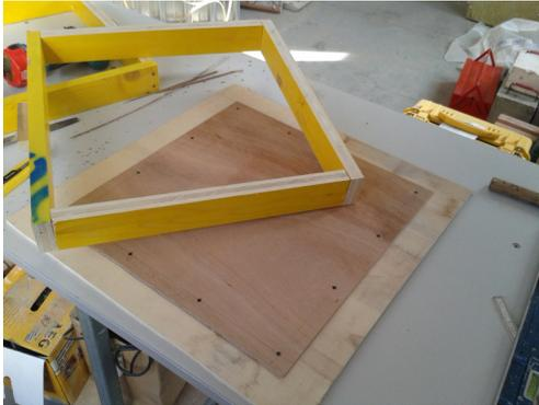
Fig. 7.76, Casseri in legno di dimensioni 50x49x6cm realizzati per dare forma ai pannelli.
