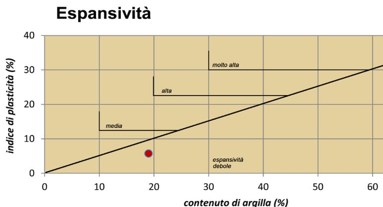
**Fig. 7.43**, Il grafico di espansività (CRATERre; Houben, Guillaud 1989) indica un grado di espansività debole per il terreno di Pozzolo Formigaro.
