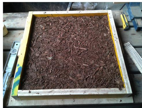
Fig. 7.85, Pannello in terra alleggerita con fibre di Poligono del Giappone realizzato. Il pannello una volta essiccato non è risultato sufficientemente coeso e resistente.
