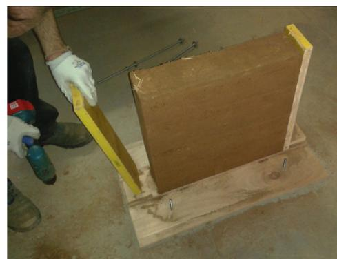
*Fig. 7.65-7.66, I campioni vengono liberati dalle assi principali mantenendo le assi di testata a protezione degli angoli.*
