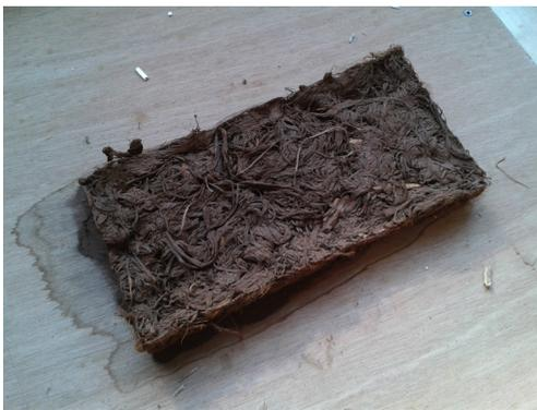
Fig. 7.87-7.88, Il provino in terra alleggerita con canapa approntato è risultato troppo basso, la fibra assorbendo l'acqua con cui è stata umidificata si è contratta fortemente
