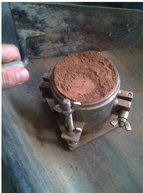
Fig. 7.50, Prova Proctor: terminata la compattazione viene rimosso lo stampo ed eliminata la porzione di terra in eccesso.
