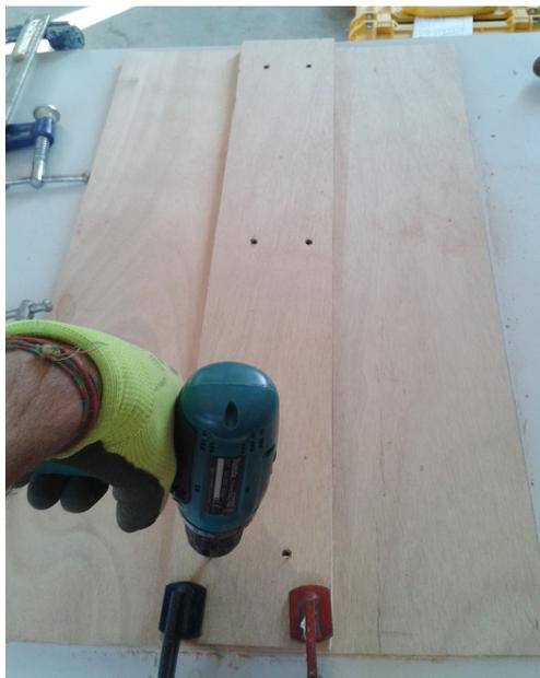
*Fig. 7.54, Costruzione casseri: montaggio del piano di supporto con doppia altezza per facilitare la messa in bolla degli elementi laterali.*
