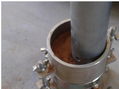
Fig. 7.49, Prova Proctor: lo stampo viene riempito per strati ed ognuno di essi viene compattato con il pestello, con 25 colpi.
