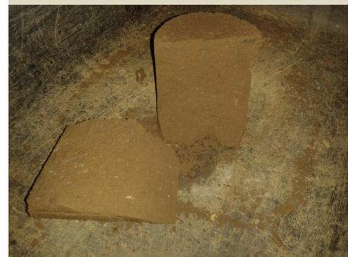
*Fig. 7.53, Prova Proctor: il campione da pesare ed essiccare viene asportato da una delle due superfici tagliate.*
