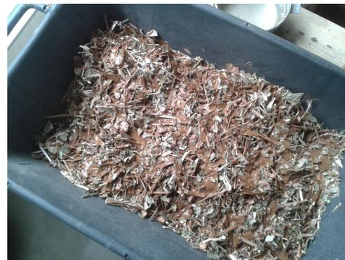
Fig. 7.84, impasto di terra e fibre di Poligono del Giappone
