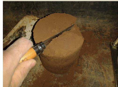
*Fig. 7.51-7.52, Prova Proctor: il cilindro compattato liberato dallo stampo viene tagliato al centro in modo da poter asportare un campione di cui verificare il contenuto reale di umidità.*
