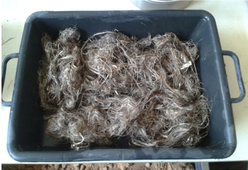
Fig. 7.86, Fibra di canapa utilizzata per il provino.
