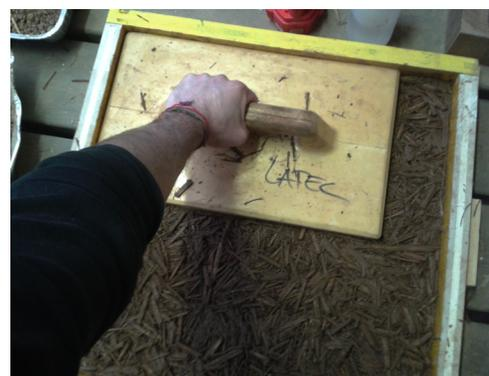
Fig. 7.79, I pannelli vengono pressati per strati con un frattazzo a superficie piana.
