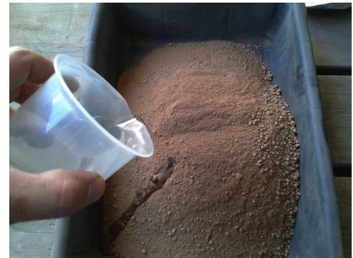
**Fig. 7.48,** Prova Proctor: il campione di terra scelto viene umidificato progressivamente con quantità d'acqua del 2-3%.
