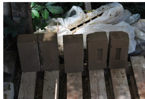
Fig. 5.17, Blocchi di Terra Compresi durante le sperimentazioni eseguite in cantiere con i partecipanti.
