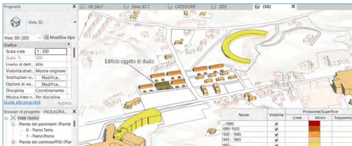
Figura 20 Visualizzazione in ambiente BIM del contesto di appartenenza dell'edificio. I manufatti sono stati modellati come masse semplificate alle quali è stata associata una serie di parametri condivisi. In figura viene evidenziata l'evoluzione storica del contesto grazie all'utilizzo di un filtro di visualizzazione basato sul parametro "Epoca di realizzazione".
