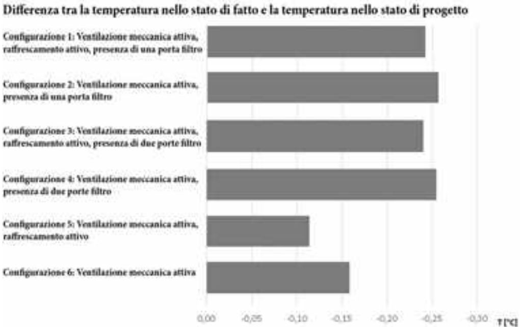
3: Differenza di temperatura nella sala dei Tirannicidi tra lo stato di fatto e lo stato di progetto in sei ipotesi di configurazione tecnologica e tecnica del varco tecnologico CapsulART.
