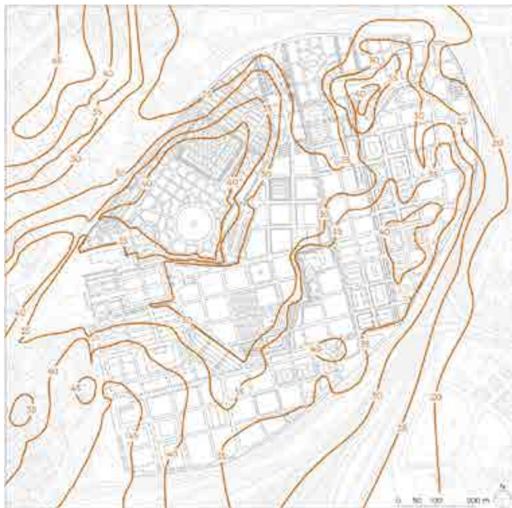
2: Roma, cimitero monumentale Campo Verano, planimetria generale. In marrone le isoipse (distanza di 5 metri) riferite all'anno 1873 e tracciate sulla "Tavoletta 150 IV SO Roma" dell'Istituto Geografico Militare [elaborazione grafica dell'autore].
