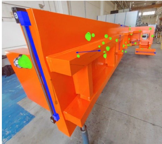
Figura 6. Visualizzazione AR del pezzo da lavorare con sovrapposti i modelli digitali dei componenti aggiuntivi da posizionare.
