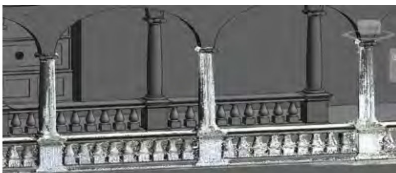
Figura 10 Confronto tra la nuvola di punti e il modello HBIM – colonnato.
