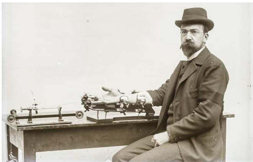
Ugolino Mosso, fratello di Angelo Mosso, si sottopone alla prova dell'ergografo per misurare la fatica muscolare, Archivio ASTUT, Università di Torino.
