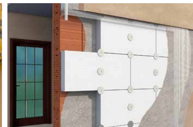
Realizzazione del cappotto termico da www.isolkappa.it
