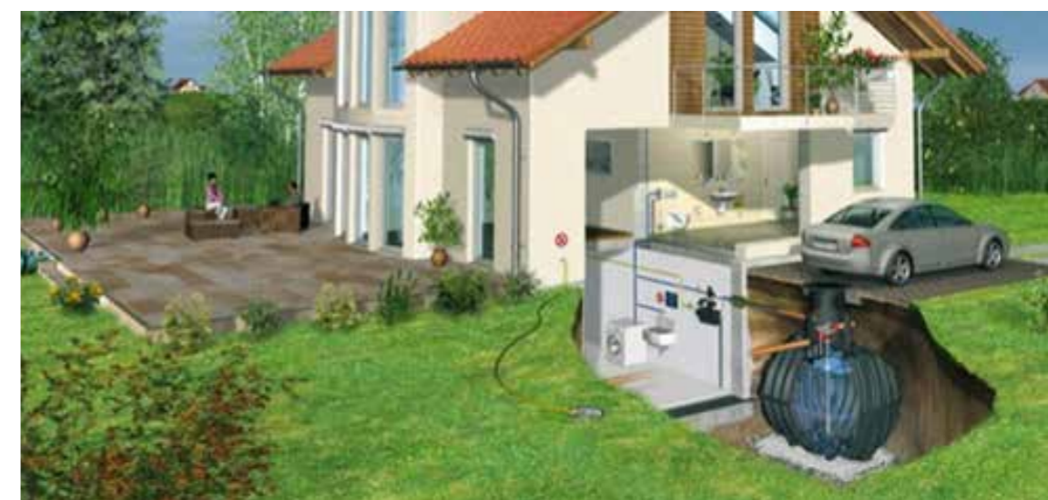
Cisterne interrante per la raccolta dell'acqua piovana da: professionalteam.biz
