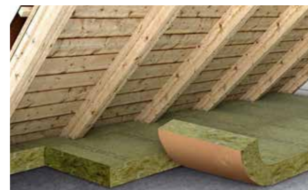
ROULROCK KRAFT – Rockwool - feltro in lana di roccia, rivestito da un lato con un foglio di carta kraft politenata con funzione di freno a vapore, ideale per l'estradosso di sottotetti non abitabili da: https://www.rockwool.com
