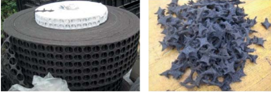
Figura 2.4.9 Substrato realizzato con scarti di feltrini sottosedie sminuzzati.
