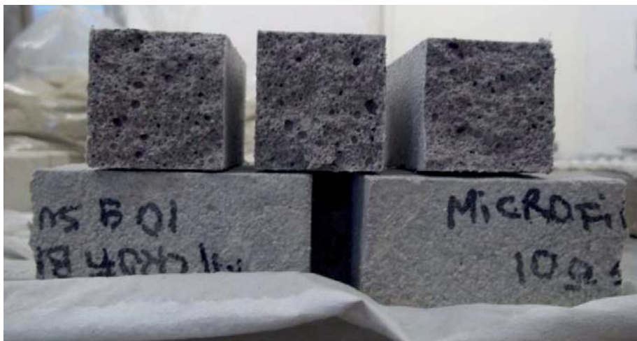
Figura 2.4.8 I campioni di intonaco realizzati con microfibre di lana e cachemere.
