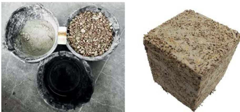
Figura 2.4.6 Componenti del mix design e prototipo del nuovo blocco.
