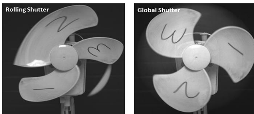
Figura 20: Confronto tra un'immagine acquisita con modalità rolling shutter e global shutter. 3
