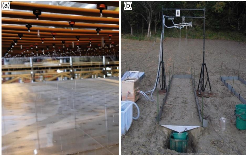
Figura 2: Esempi di simulatori di pioggia: (a) un simulatore di a goccia per studi di ruscellamento superficiale [32]; (b) un simulatore ad ugello per studi di erosione del suolo [13].
