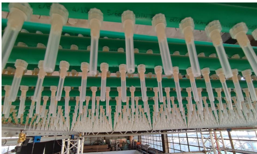
Figura 39: Piano inferiore di gocciolamento equipaggiato con sistema di copri-aghi.
