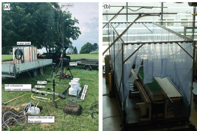
Figura 1: Esempi di simulatori di pioggia: (a) un simulatore di campo per studi di ruscellamento superficiale [25]; (b) un simulatore di laboratorio per studi di erosione del suolo 1 .
