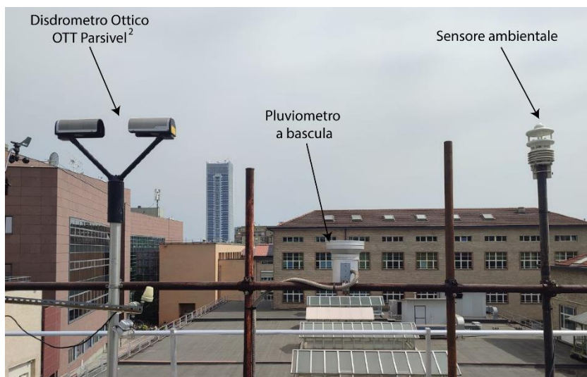
Figura 3: Immagine della sensoristica installata nella stazione meteo sul tetto del laboratorio.
