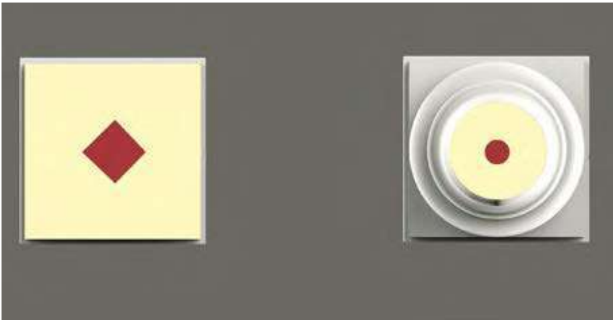
Fig. 1. Nocciolo centrale di inerzia di un pilastro e di un fusto di colonna con lo stesso quadrato di base [elaborazione degli autori].
