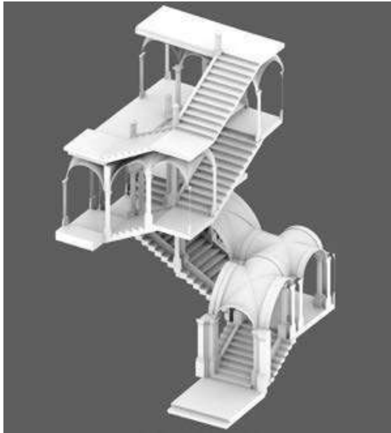
Fig. 6. Vista assonometrica dello sviluppo della scala di palazzo Butera a Palermo, vista da modello 3D [elaborazione grafica a cura di Gaia Nuccio].
