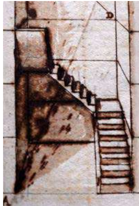
Fig. 2. Prospettiva di scala "alla trapanese", a sviluppo quadrato e in cassa aperta. Disegno (metà XVI secolo), Siracusa, Biblioteca Comunale, ms. Architettura, A 2 10.
