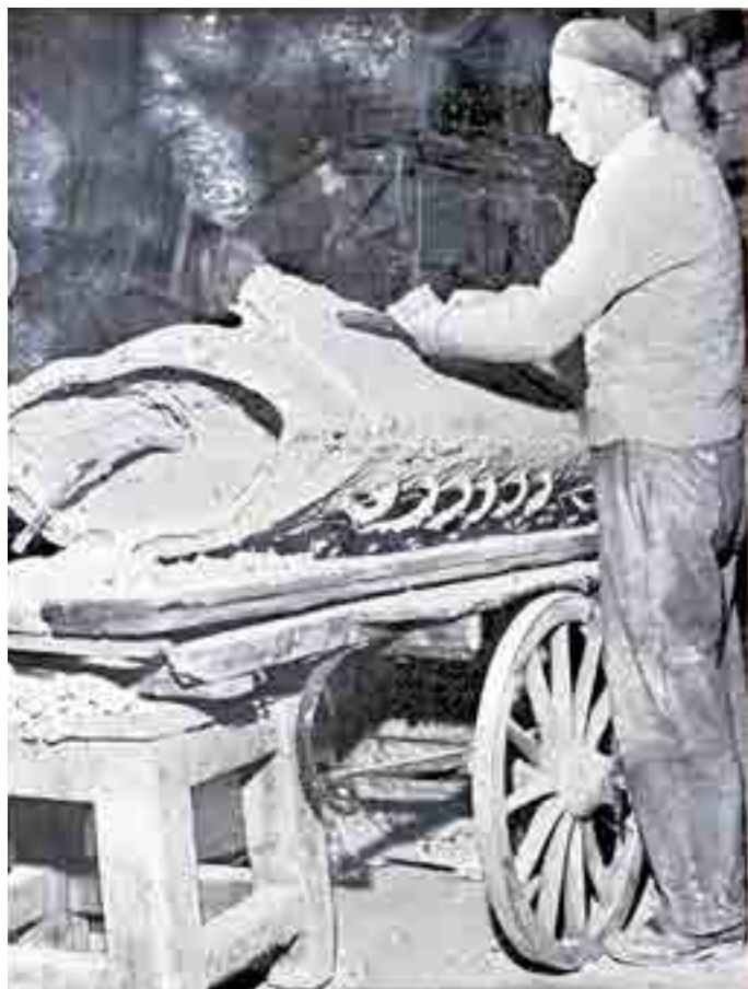
4: Attività di fonderia lavoratura e sistemazione delle terre di fusione (1959).
